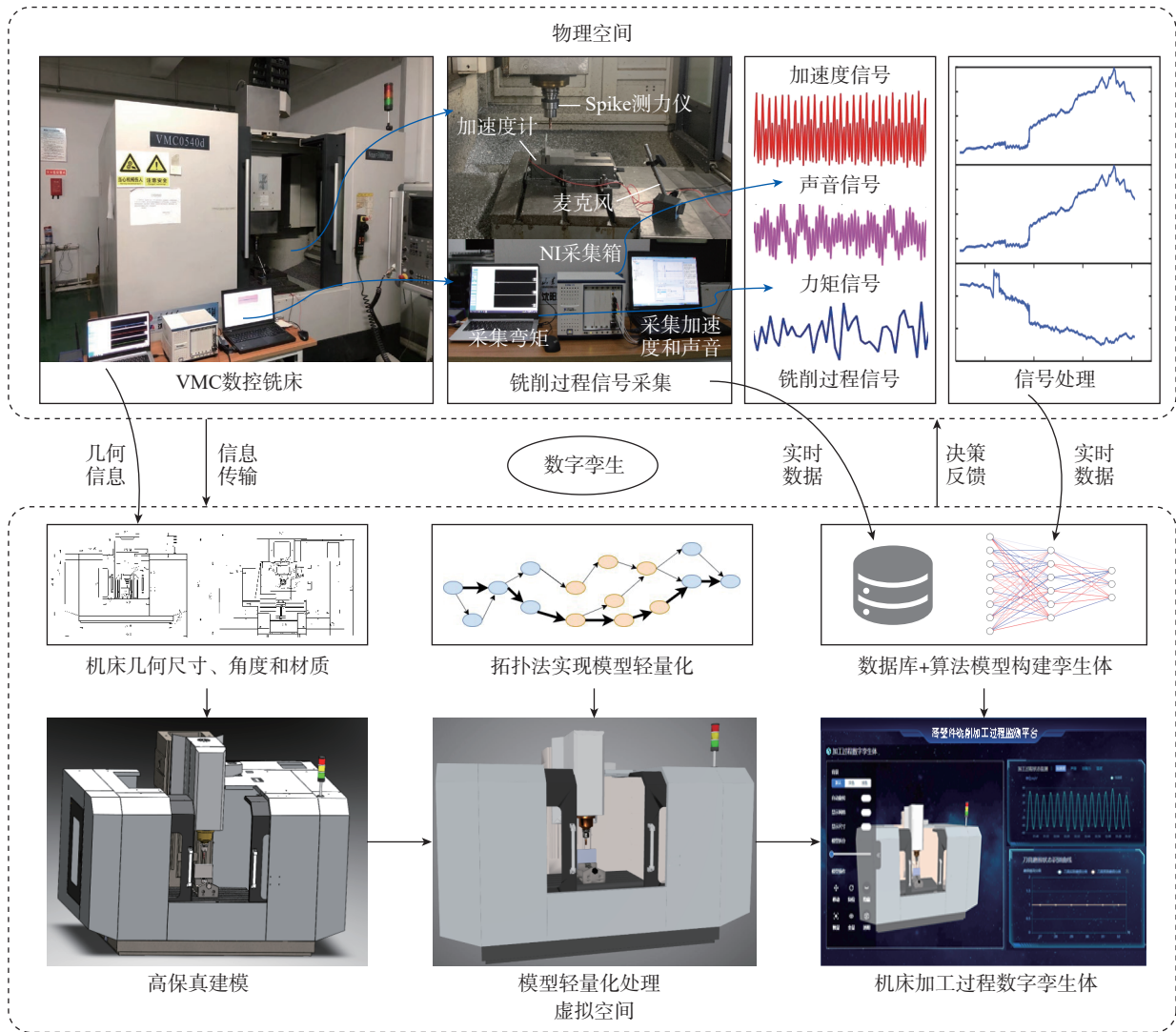
图1 数字孪生驱动的工具磨损状态识别框架
